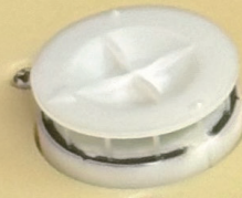
機器組み込み用 超低背タイプの微風センサ
